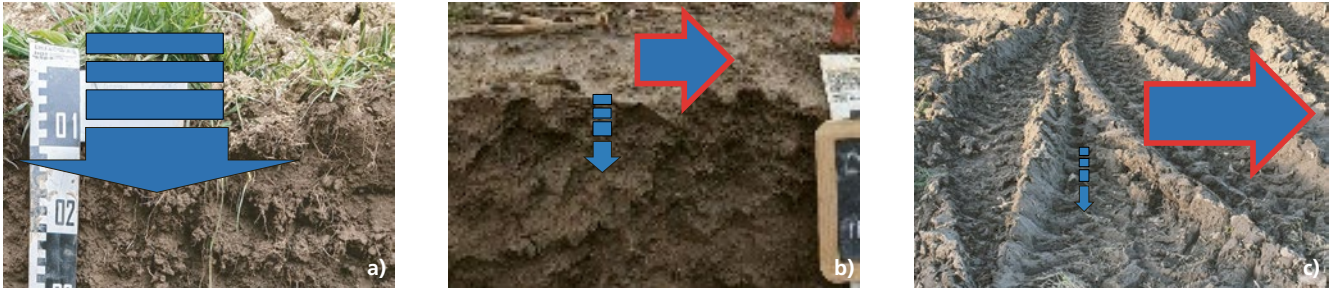
Abbildung 6: Struktur der Bodenoberfläche und Geschwindigkeit der Wasserinfiltration a) poröse Struktur: > 100 mm/h, b) Verdichtungsschicht: < 10 mm/h, c) Verdichtung: < 1 mm/h
